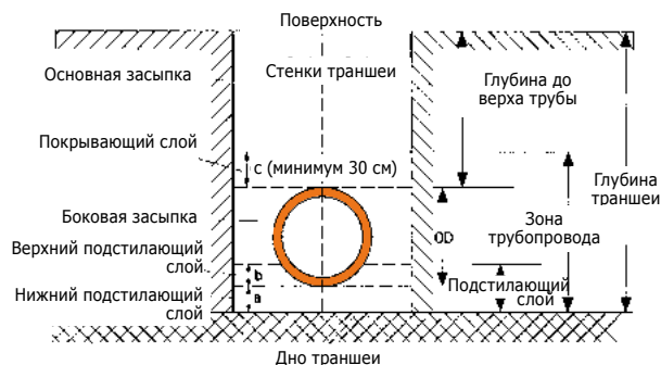
Рис. 3 Устройство траншеи
