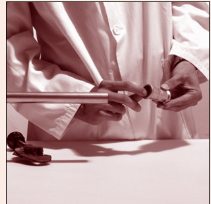
Fig. 23 Проверка наличия и расположения колец уплотнительных Checking the presence and positioning of o-rings
