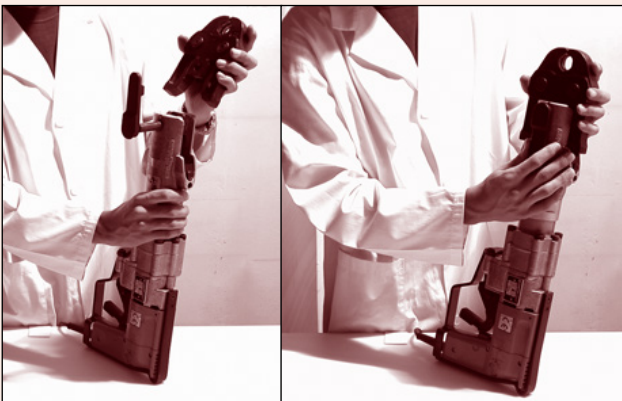
Fig. 27 Сборка монтажного инструмента Pressing tool assembly
