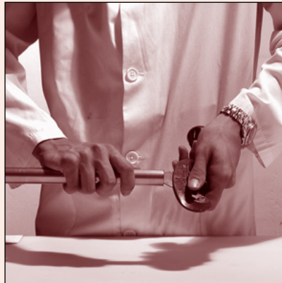
Fig. 22 Удаление заусенцев с труб Pipe-end deburring
