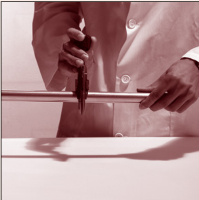
Fig. 21 Резка труб Pipe cutting
